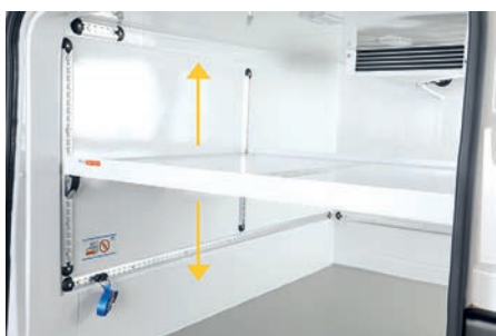
Individuelle Ausstattung: höhenverstellbares Zwischenbodensystem für eine zweite Ladeebene
